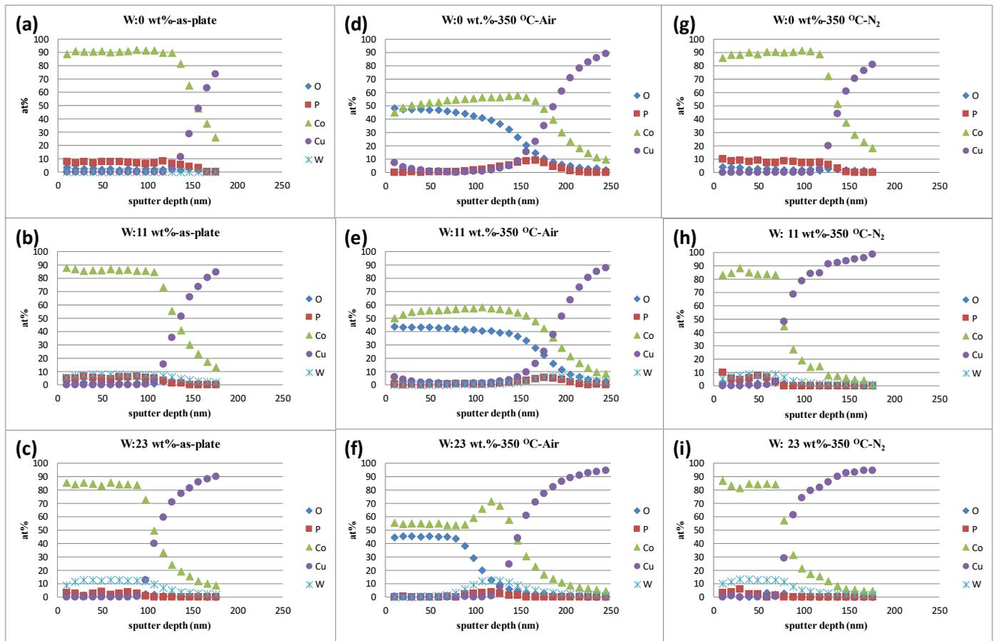
Fig. 4 XPS depth profile ((a)~(c) : as-plate, (d)~(f) : Air, 350°C-1h, (g)~(i) : N<sub>2</sub>, 350°C-1h)
